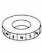
a) Mehrpolig am Außenumfang magnetisiert
